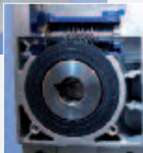
Die Fangvorrichtung verhindert im Notfall den Absturz des Torbehanges.
