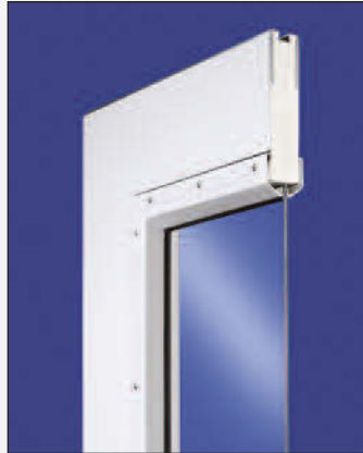
SAN-Doppelscheibe 18 mm, VSG 6 mm bzw. ISO-VSG 21 mm, mit Stahl-Glasleisten. Neu: Schlagregendichtigkeit Klasse 3
