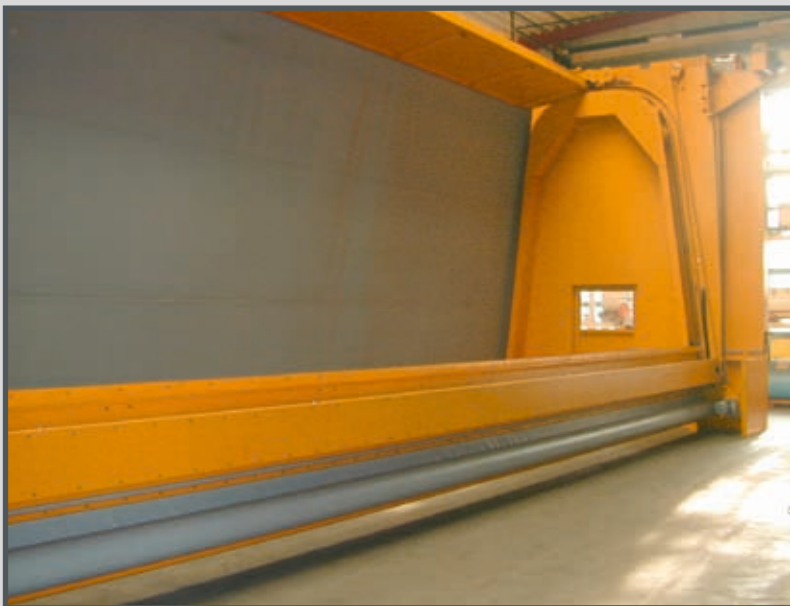
BeluTec-Einhausung bis 24 Meter breit für Querdurchlauf mit Absaugung
