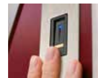
Fingerprint, Scanner und Steuereinheit im Türblatt integriert
